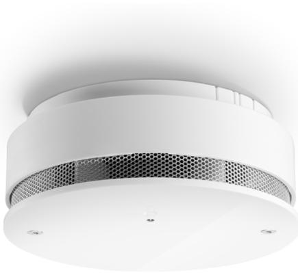
Optischer Rauchmelder für Loop 3000 zur Brandfrüherkennung und -meldung, mit zwei optischen Sensoren und bidirektionalem Isolator nach EN 54-7 und EN 54-17. Im Flach-Design rund
